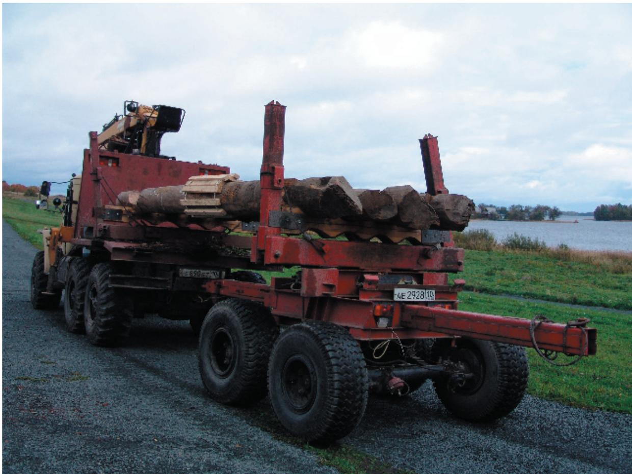
фото 9. Транспортировка на специально оборудованной машине небольшого количества бревен
