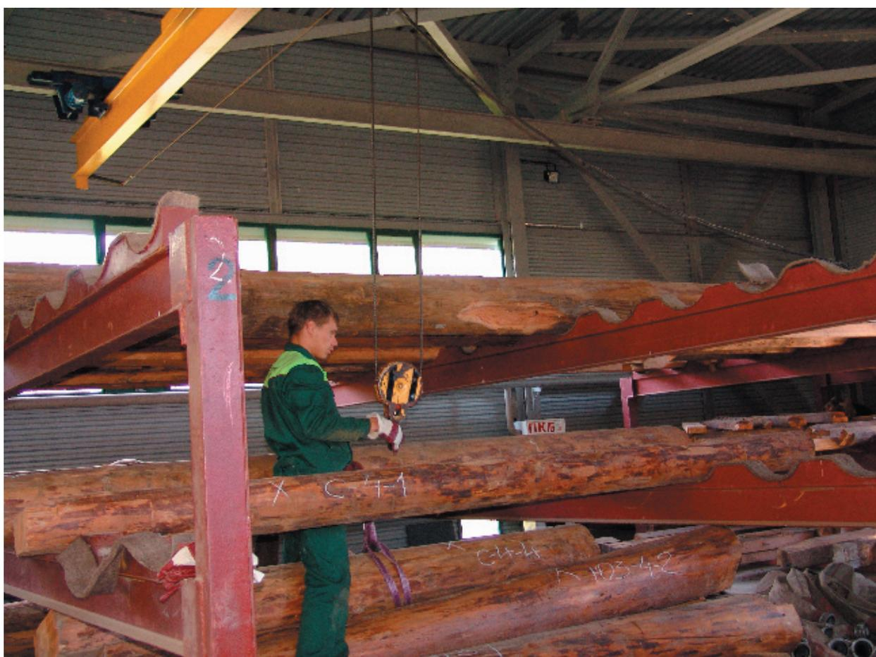
фото 10. Укладка в штабеля на войлочные прокладки элементов сруба на Реставрационном комплексе
