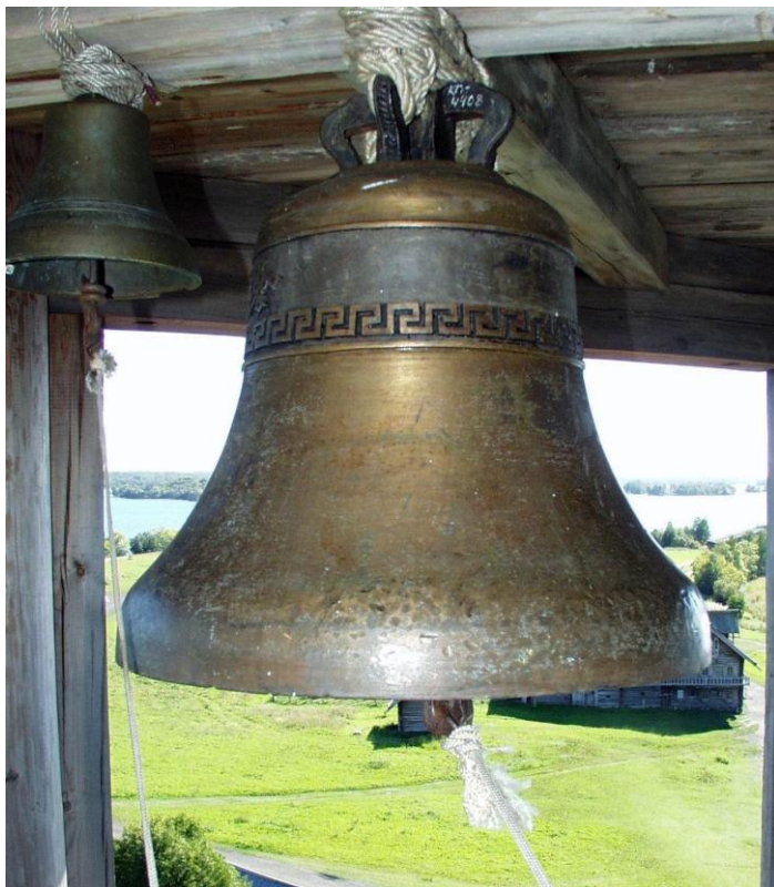
Рис. 5. Колокол (КП-4408). Завод А. С. Лаврова, Гатчина, конец XIX — начало XX в. Диаметр — 50,5 см, высота — 54 см, вес 5 п. 15 ф. (фото Н. Г. Павловой, 2004 г.).
